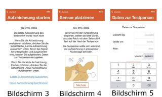
Bildschirm 3-5 Gerät bestätigen (falls mehrere Geräte verfügbar sind), Befestigung auf dem Brustkorb und Eingabe von Daten.
